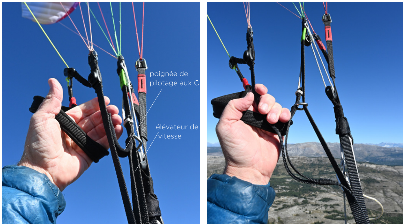
FIG.1: Placez vos doigts de part et d'autre de l'élévateur et attrapez la poignée pour appliquer de la tension sur les C.
