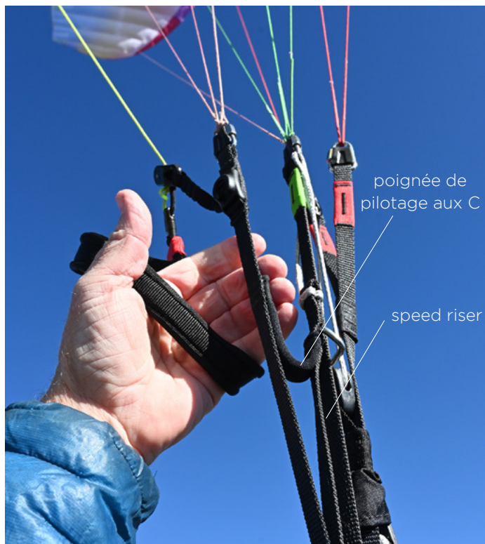
FIG.1: Placez vos doigts de part et d'autre de l'élévateur et attrapez la poignée pour appliquer de la tension sur les C.
