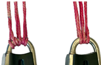
Links: Schlaufen auf Maillons; Rechts: gelöste Schlaufen.
