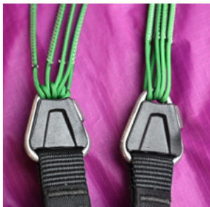
Links: Schlaufen auf Maillons; Rechts: gelöste Schlaufen
