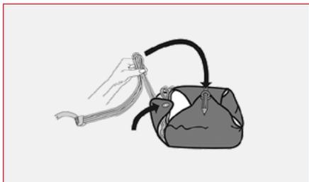
**ETAPE 16:** Fermer le quatrième rabat et glisser une boucle de lovage du suspentage (environ 4 cm) dans l'élastique principal pour assurer la fermeture du pod.
