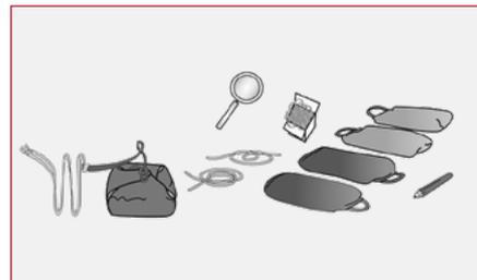
**ETAPE 18:** Vérifier que le matériel listé au début du pliage soit complet et que par conséquent aucun accessoire de pliage ne soit resté dans le parachute plié.
