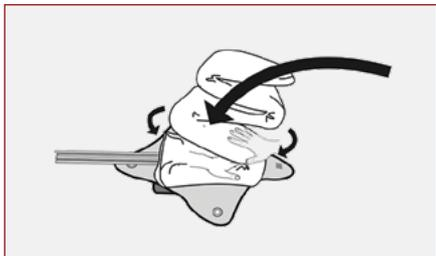
**ETAPE 13:** Lover la voilure à l'intérieur du pod en ménageant un petit espace en avant de la voilure pour le lovage ultérieur des suspentes.
