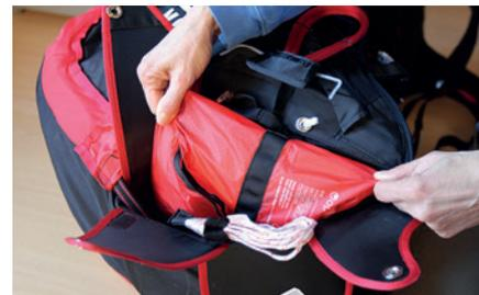
Insérer le parachute dans le conteneur avec la sangle d'attache poignée au dessus (coté plateau assise) et les suspentes en dessous (fond de la sellette).
