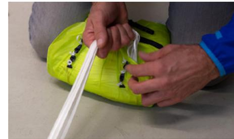
Schließen Sie die ersten drei Innencontainerklappen und sichern Sie diese mit einer kleinen Schnur. Diese Methode vermeidet Verbrennungen durch Reibung bei einer Auslösung, da das Leinenbündel zuerst freigegeben wird und nicht mit dem Kappentuch in Kontakt kommt.
