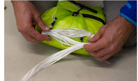
Beginnen Sie an der Verbindungsleine und schleifen Sie die Leinenbündel in Form einer Acht. Verwenden Sie Gummiringe auf Silikonbasis, um die Leinenbündel zu befestigen. Die Achter sollten auf die gleiche Breite wie die Einsatztasche des Innencontainers gebracht werden. Lassen Sie ca. 30 cm frei für die letzte Leinenschleife.
