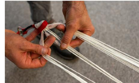
Stellen Sie sicher, dass die Leinen frei von Verdrehungen und Verwicklungen sind - beginnen Sie an der Verbindungsleine und arbeiten Sie in Richtung Fallschirm, wobei Sie die Scheitelleine in der Mitte und die Fangleinen auf beiden Seiten voneinander trennen. Stellen Sie sicher, dass keine der Leinen um die Scheitelleine oder untereinander verdrillt ist.
