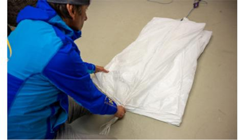
Legen Sie die Kappe mit einem der vier Eckpunkte unten, einem links, einem rechts und einem oben aus. Beginnen Sie mit der ersten Ecke unten und glätten Sie das Material, indem Sie mit der Hand darüber entlangfahren.
