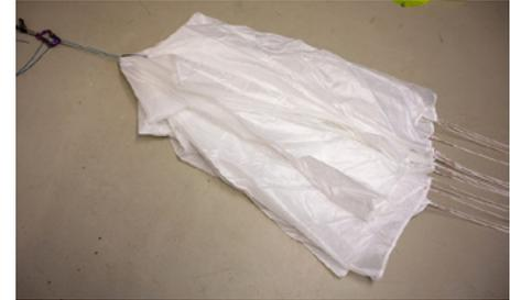
Verwenden Sie die Packleine, um die Packschlaufen zusammenzufädeln. Vergessen Sie nicht die vier Eckschlaufen, die etwas weiter hinten an den Bahnen angebracht sind. Befestigen Sie die Packschlaufen an etwas Starrem und ziehen Sie an der Verbindungsleine und den daran befestigten Schlaufen, bis die Fangleinen gespannt sind..
